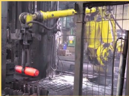
ガザで多数使われる155ミリ榴弾を製造する ファナック・ロボット 出典：イスラエル国防軍SNS投稿
