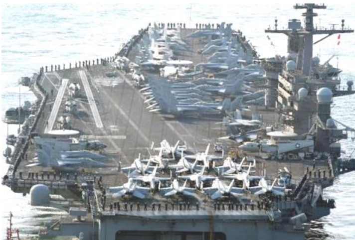
『原子力空母カール・ビンソン(ニミッツ級)』 排水量約10万トン、全長約330m(東京タワーと同じ)、速度30ノット(1200キロを一日で移動)、艦載機約71機(3分間に1機の間隔で発艦)。500キロ先の敵に3日間で2千トンの弾薬を投入する能力を持ち、大都市、軍事要塞を壊滅させる力があるといわれている。
